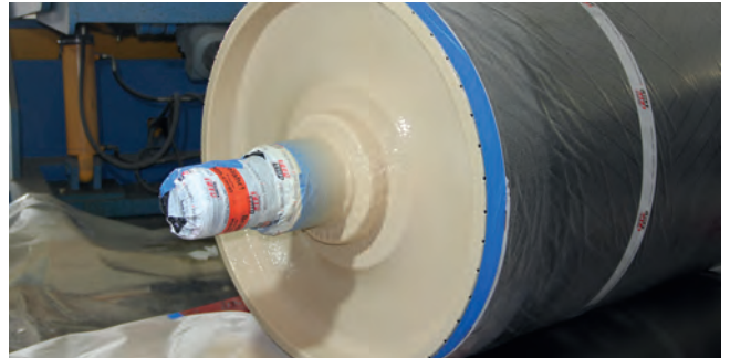
Die Stirnseiten der heißgummierten und profilierten Umlenktrommel sind mit ca. 3 mm Polyurea beschichtet.
