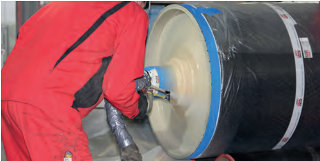
Die Stirnseiten der heißgummierten und profilierten Umlenktrommel sind mit ca. 3 mm Polyurea beschichtet.
